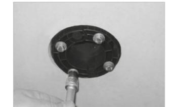
**3. Schrauben in mehreren Durchgängen über Kreuz anziehen – Anzugsmoment 6 Nm.**
