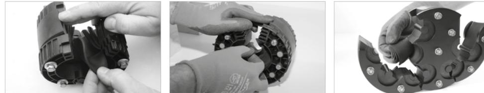
**2. Dichtelement aufklappen. Zwiebelringe nach Erfordernis herausziehen, anschneiden und abreißen.**
