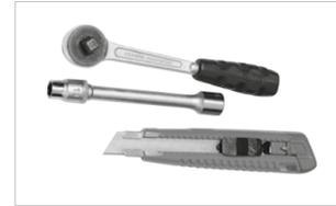
Das Entfernen der Dichtwiebel für den erforderlichen Mediumleitungsdurchmesser erfolgt mit Hilfe eines scharfen Messers oder durch einfaches Abreißen. Das Festziehen der Schrauben erfolgt mit einer Stecknuss 10 mm, der kurzen Verlängerung und einer Ratsche mit Drehmomentauslöser.
